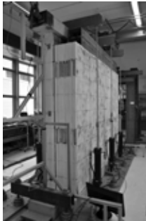
Prototyp des Wandsystems im Prüfstand
